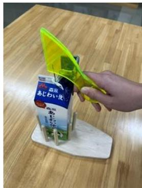
そこで、接着したガイドをパックの角に沿わせながら針を刺すことで、刺す工程が容易になるよう設計している。
